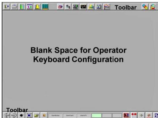
Рисунок 1 – Свободная зона обеспечивает пространство для создания специфической пользовательской операторской клавиатуры.
