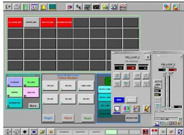
Рисунок 3. – Панель управления помещается на предназначенную зону экрана с размером клавишей ввода данных, настраиваемым для сенсорного использования.
