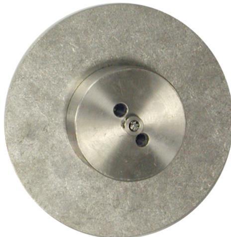
Комплект, состоящий из груза и центрирующего диска—для реализации Метода для сред с низкой диэлектрической постоянной
